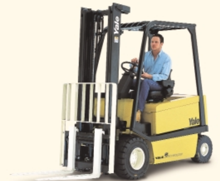
Drehstromtechnik sorgt dafür, dass ALF-Stapler auch bei voller Last zügig und bedarfsgerecht arbeiten.
