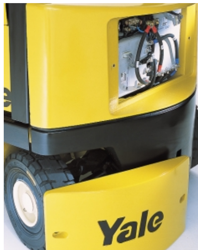
Vereinfachte Verkabelung dank CAN-Bus-Technik. Die Steuerung befindet sich im Kontergewicht. Hier ist sie gegen Staub und Spritzwasser sicher geschützt.
